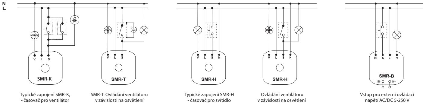
Poznámka: Výrobky SMR-K, SMR-T, SMR-H nejsou určeny pro spínání kapacitních zátěží (úsporné žárovky a LED žárovky s kapacitním napájením atd.), jsou určeny pouze pro spínání odporové a induktivní zátěže (klasické žárovky, ventilátory apod.). Pro ostatní typy zátěží je určen SMR-B s reléovým výstupem. Tímto výstupem je možné spínat zátěž charakteru R, L nebo C – v hodnotách uvedených v zátěžové tabulce.
